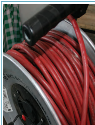
Oftmals ist die Stromversorgung unterbrochen. Sorgen Sie mit geeigneten Verlängerungskabel und Kabeltrommeln vor. Achten Sie auf Feuchtraumqualität.
